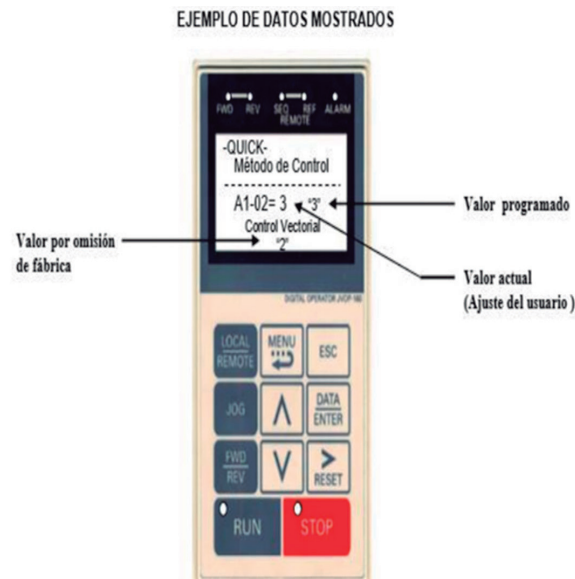
Figura 30 Convertidor de frecuencia variable
